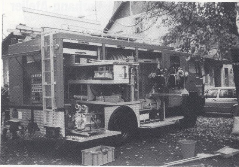
Das neue Pikettfahrzeug von der Firma J. + S. Simon, Rapperswil, ein Mercedes-Benz, Typ AF/36, 4 x 4, unterscheidet sich äusserlich vom Tanklöschfahrzeug vor allem dadurch, dass es eine Doppelkabine hat und somit mindestens sieben Mann mitführen kann. Im Aufbau ist kein Wassertank eingebaut. Es führt vor allem Atemschutzgeräte, Pionier- und Löschmaterial mit. Auf dem Fahrzeug ist ein Lichtmast eingebaut. Das Pikettfahrzeug ist die ideale Ergänzung zum Fahrzeugpark der Feuerwehr Oberentfelden.
