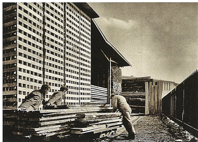
127 Bretterlager. Hier wurden die Bretter zwei Jahre getrocknet. Q112
