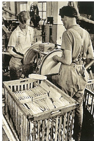
050 Schleifen von Zahnbürstenkörpern Q28
