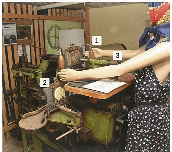
091 1 Steuerung, muss von Hand verschoben werden. 2 Hier müssen die Borsten eingefügt werden. Gleichzeitig wird ein Draht von rechts herangeführt und mit den Borsten ins Loch eingeführt. 3 Das nächste Bürstenholz wird gleichzeitig gebohrt
